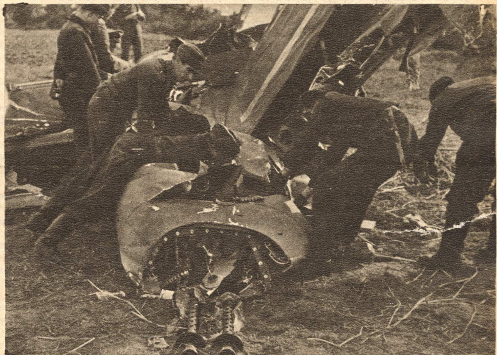
Männer des Bergungstrupps beim Ausbau der Heckkanzel eines zerschmetterten Viermotorigen. Deutlich sind die beiden schweren Maschinengewehre zu erkennen
